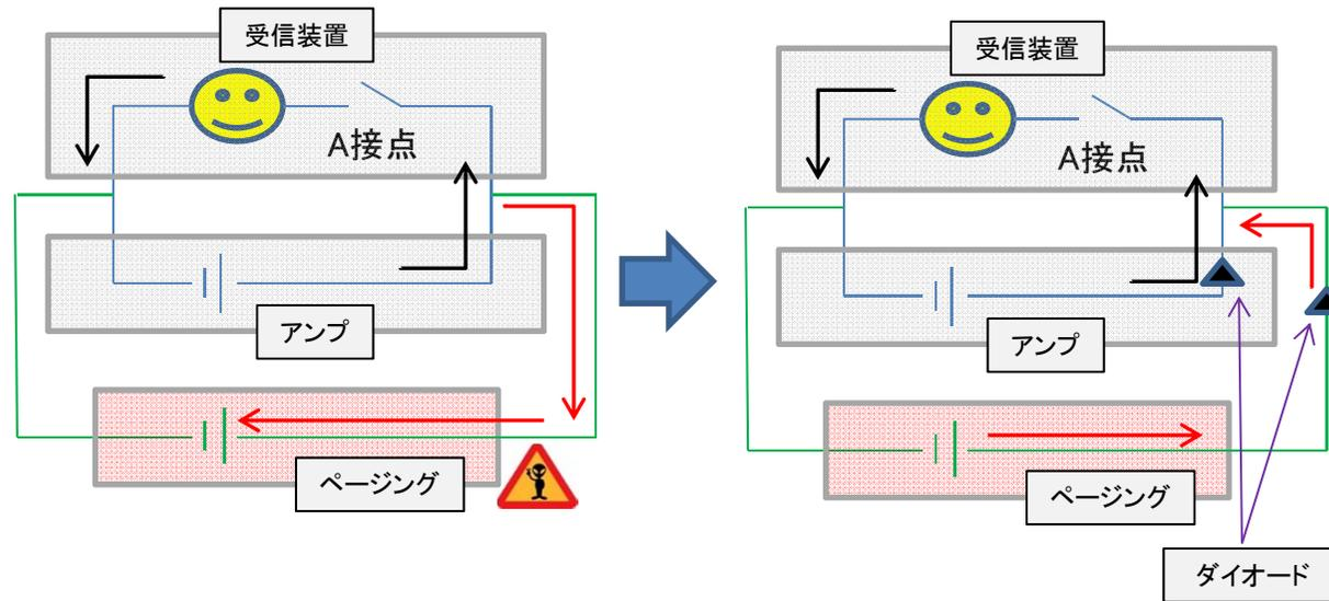
接点出力の平行接続をすると、1つの接点で2つ以上の機器を制御出来るというメリットがありますが、機器によっては回路ショート、逆電流によりページングなどを壊す場合がありますのでご注意ください。対応方法として、電流逆流防止のダイオード等を入れる必要がありますが、この場合であっても2つの機器の電圧差が大きいと機器を壊すリスクもあるのでご注意ください。
